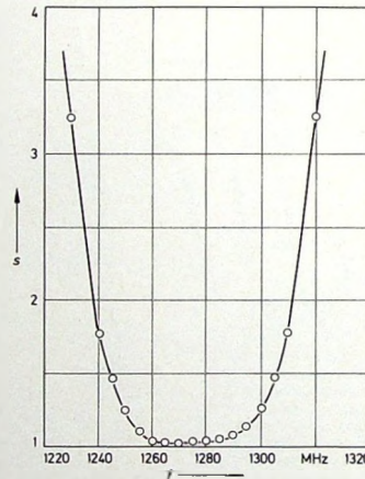
Bild 26. Reflexionsverlauf des Stripline-Filters
